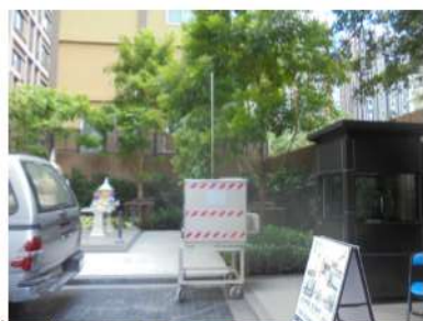
ภาพที่ 5 ติดตั้งเครื่องตรวจวัดก๊าซมลพิษทางอากาศ \text{CO}_2 , \text{SO}_2 , \text{NO}_2 , HC
